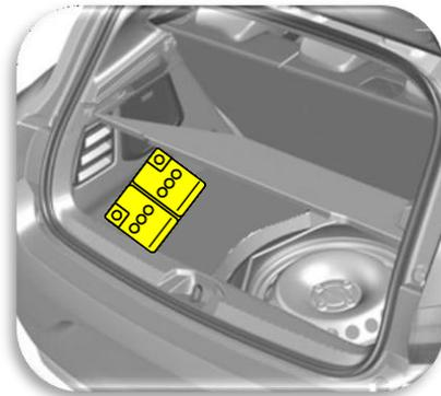
Bei Airbagauslösung schaltet sich die 12V-Batterie automatisch aus
